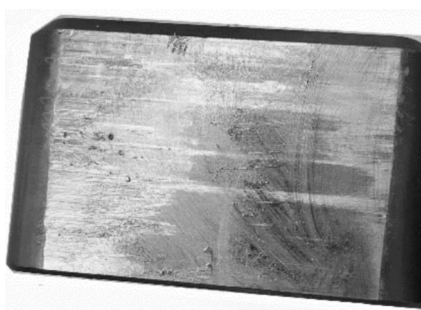
图8 拉伤烧结的导向面
